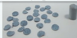
Fotocatalizzatore composito ZVI/ZnS_sPS
